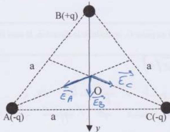
1- Représenter sur le schéma ci-dessus les vecteurs champs électriques  $\vec{E}_A(O)$ ,  $\vec{E}_B(O)$  et  $\vec{E}_C(O)$  créés par les trois particules chargées au centre O du triangle.
