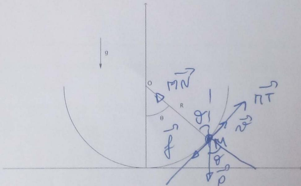
On s'intéresse au mouvement d'un objet M de masse  $m$  le long d'un demi-cercle de rayon  $R$  et de centre  $O$ . Les frottements pouvant être modélisés par :  $\vec{f} = -a\vec{v}$ . La masse  $m$  est lâchée à un angle  $\theta_0$ , sans vitesse initiale.
