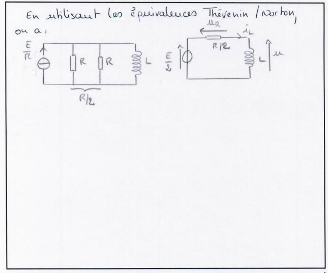
β. En utilisant les résultats précédents, établir l'équation différentielle qui régit le circuit et trouver alors l'expression de  $i_L(t)$ . Vous donnerez cette équation en fonction de E, R et L. Quelle est la constante de temps τ de ce circuit ?
