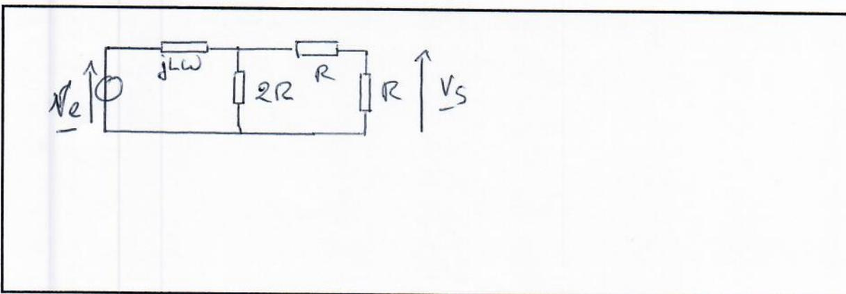
b. Exprimer la fonction de transfert de ce filtre en fonction de  $R$ ,  $L$  et  $\omega$ .
