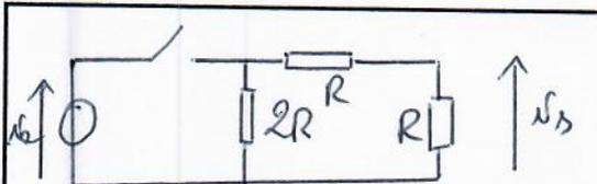
En THF, la bobine est équivalente à un interrupteur ouvert.
