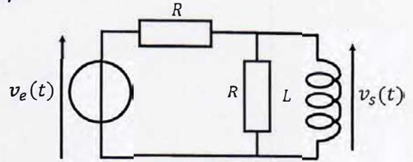
1. Etude Qualitative : Calculer les limites du gain quand  $f \rightarrow 0$  et quand  $f \rightarrow \infty$  et en déduire le type de filtre. Que vaut l'amplification maximale ?
