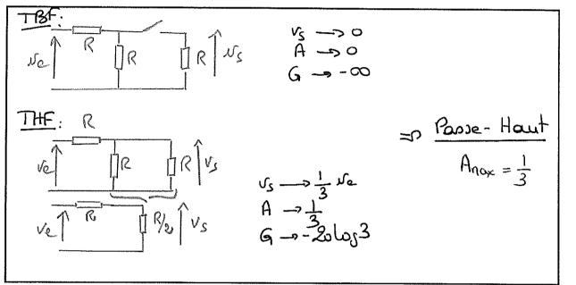
2. Déterminer sa fonction de transfert. En déduire la pulsation de coupure.
