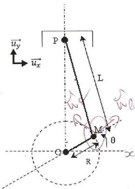
Un vilebrequin est une pièce mécanique d'un moteur thermique permettant la transformation d'un mouvement de translation sur l'axe Oy (piston P) en un mouvement de rotation (point M). On suppose que le moteur possède une rotation à vitesse angulaire  $\omega$  constante, d'où la position angulaire au cours du temps  $\theta(t) = \omega t$ . La longueur L est également constante.
