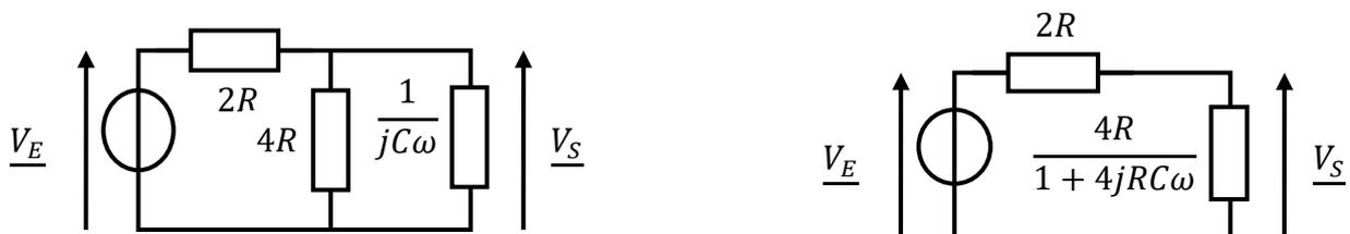
D'après la formule du Pont Diviseur de Tension, on obtient :
